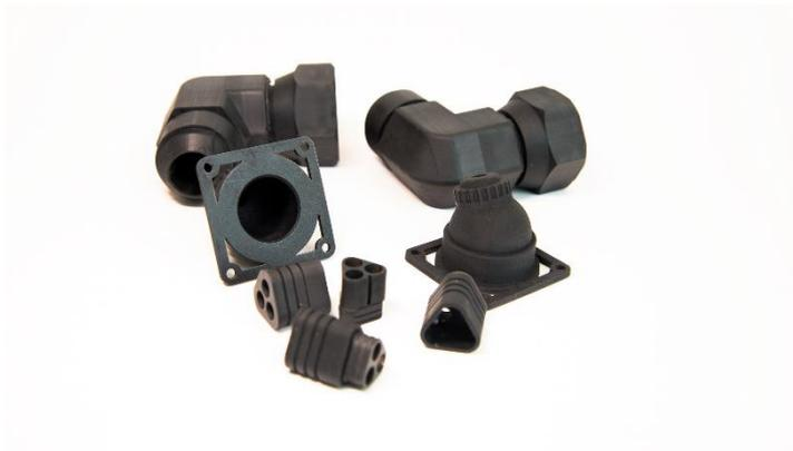
Flamm-, Rauch- und Toxizitäts-beständige Demo-Anwendungen von Henkels neuem Photopolymer, die auf dem Origin One Drucker produziert wurden: Elektrische Rundstecker und L-förmige Rohrverbindungsstücke.
