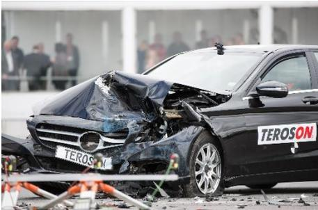
Die mit Teroson-Technologie verklebte Frontscheibe hielt nicht nur den extremen Crash-Test-Bedingungen stand, sondern lieferte auch Messwerte, die für eine volle Funktionalität des Beifahrerairbags notwendig sind.
