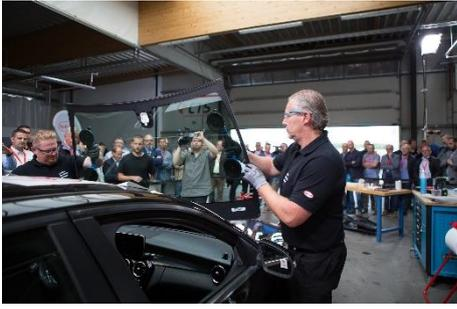
Zunächst wurde beim Testfahrzeug live die Frontscheibe ausgetauscht und mit Teroson PU 8730 HMLC verklebt.
