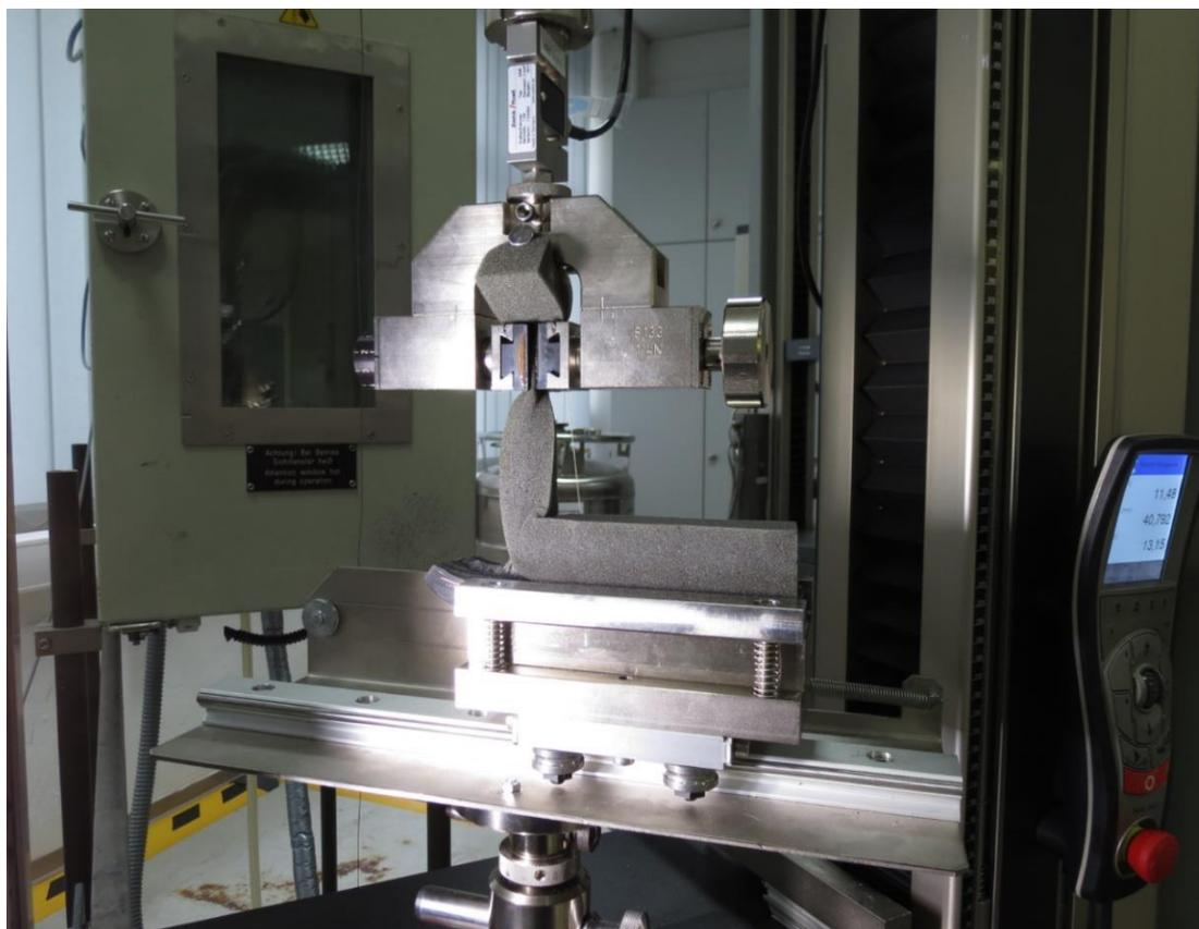
Umfassende Tests haben die ausgezeichnete Klebkraft und Elastizität von Loctite SI 5930 FIT für verschiedenste Reifenkautschukgüten, Schalldämmschäume und Trennmittel bestätigt. Das Foto zeigt die Testanordnung für einen 90-Grad-Schaum-Schältest.
