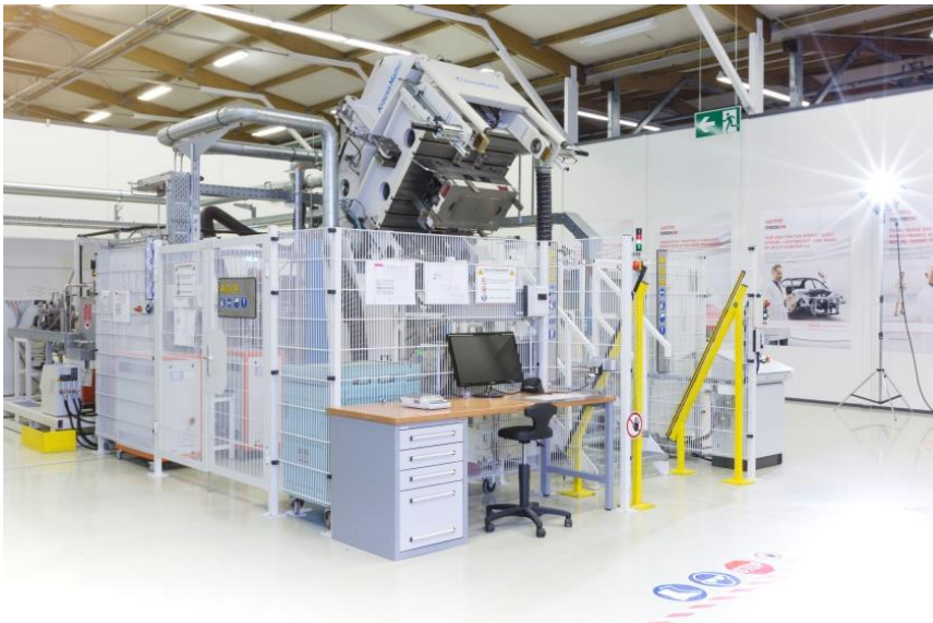
Die Hochdruck-RTM-Anlage im Henkel Composite Lab in Heidelberg, mit der Kunden seriennahe Versuche durchführen können. Die Hochdruck-RTM-Anlage verfügt über Harzinjektionseinheiten für Polyurethane und Epoxidharze gekoppelt mit einer 380-Tonnen-Pressen.
