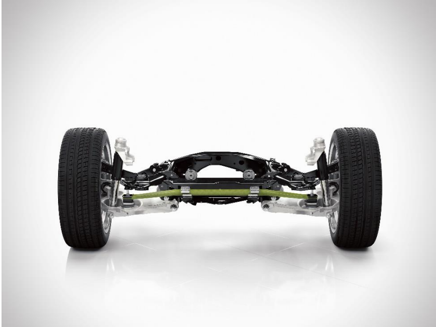
Die Hinterachse mit Querblattfeder, die Volvo jetzt auch in seiner neuen Luxuslimousine S90 und dem Premium-Kombi V90 einsetzt.
