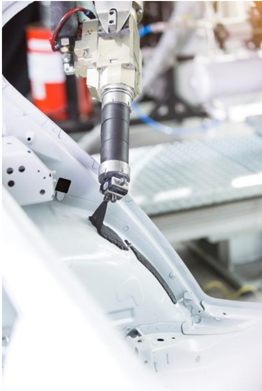
Gewichtsparend, sauber und effizient: Automatisierter Auftrag spritzbarer Schalldämpfungsmassen (LASD) in der Lackiererei. (Foto: Henkel, PR015)
