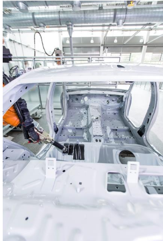
Neue innovative, spritzbare Schalldämpfungsmassen für die Automobilindustrie. (Foto: Henkel, PR015)
