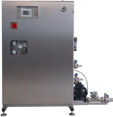
Die Glue-Mix-Einheit führt dem Klebprozess kontrollierte Mengen Luft zu.
