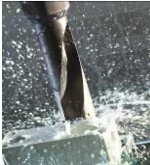
In der Metallbearbeitung sorgen Kühlschmierstoffe dafür, dass sich Werkzeuge beim Bohren, Fräsen, Drehen oder Schleifen selbst unter anspruchsvollen Einsatzbedingungen nicht so schnell abnutzen.
