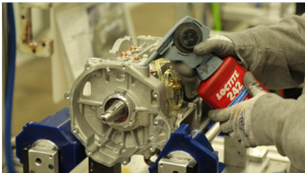
Ein Polaris Monteur trägt Schraubensicherung Loctite 242 auf die Gewindebohrungen für die Befestigung der Motoraufhängung auf.
