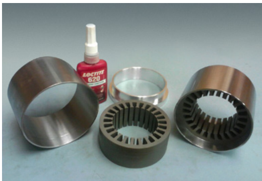
Fügeklebstoffe verbinden zylindrische Metallteile ohne Gewinde. Sie füllen den Spalt zwischen den ineinander gefügten Teilen aus und bilden nach der Aushärtung eine stoffschlüssige Verbindung.
