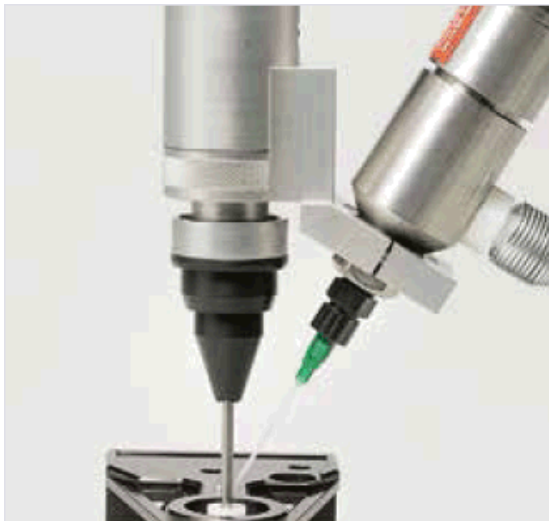
Mit einem speziell konstruierten Rotorspray-System wird eine definierte Klebstoffmenge als umlaufende Raupe oder Band auf eine vorher festgelegte Stelle dosiert.
