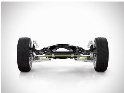
Anstatt der sonst üblichen Schraubenfedern wird an dem Fahrwerk des neuen Volvo XC90 eine quer eingebaute faserverstärkte Komposit-Blattfeder eingesetzt. BENTELER-SGL produziert diese Komposit-Blattfedern mit Loctite Matrixharz von Henkel in Großserie.
