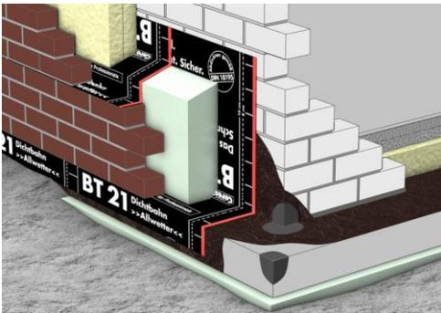
Rund ums Haus dabei: Die BT 21 Dichtbahn Allwetter kommt auch als Z- oder L-Abdichtung, etwa an Ecken oder bei Hausöffnungen, zum Einsatz. (Foto: Ceresit Bautechnik)
