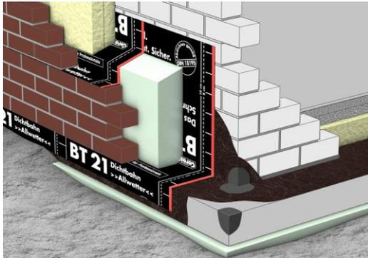
Mit der kaltselfklebenden Dichtbahn BT 21 lassen sich auch L- und Z-Abdichtungen normgerecht erstellen. (Foto: Ceresit Bautechnik)
