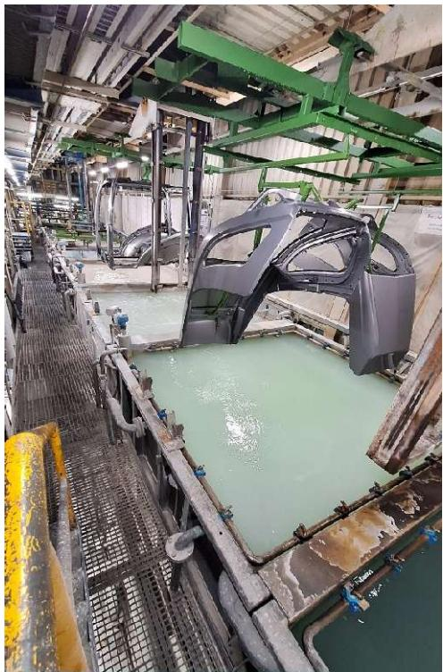
Bonderite C-AD 20202 ist ein neues Niedrigtemperatur-Tensid für die industrielle Tauchentfettung, das bereits bei rund 35 bis 40 Grad Celsius zuverlässig reinigt.
