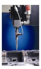
Mit dem entsprechenden Prozess Know-How ermöglicht Henkel die einfache und effiziente Applikation seiner Flüssigdichtungen.
