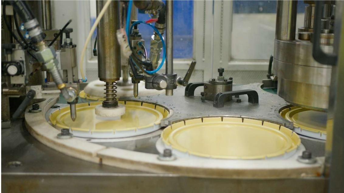
Das einkomponentige Klebstoffsystem Darex COV 73 wurde für die Applikation per Düse optimiert und zeichnet sich durch stabile Viskosität, hohe chemische Beständigkeit gegenüber Lösungsmitteln, Ketonen und Ölen sowie thermische Belastbarkeit aus.
