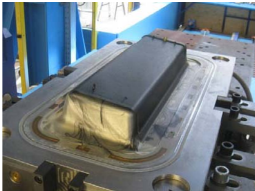
Bild 1: Geöffnete Form von Ningbo Huaxiang (CN) mit dem unbearbeiteten Bauteil vor der Entnahme (KraussMaffei in München).
