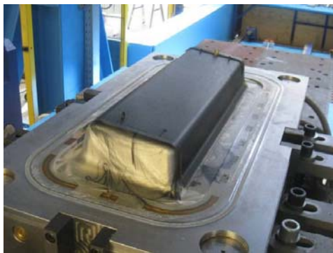
Geöffnete Form mit dem unbearbeiteten Bauteil vor der Entnahme (KraussMaffei in München).
