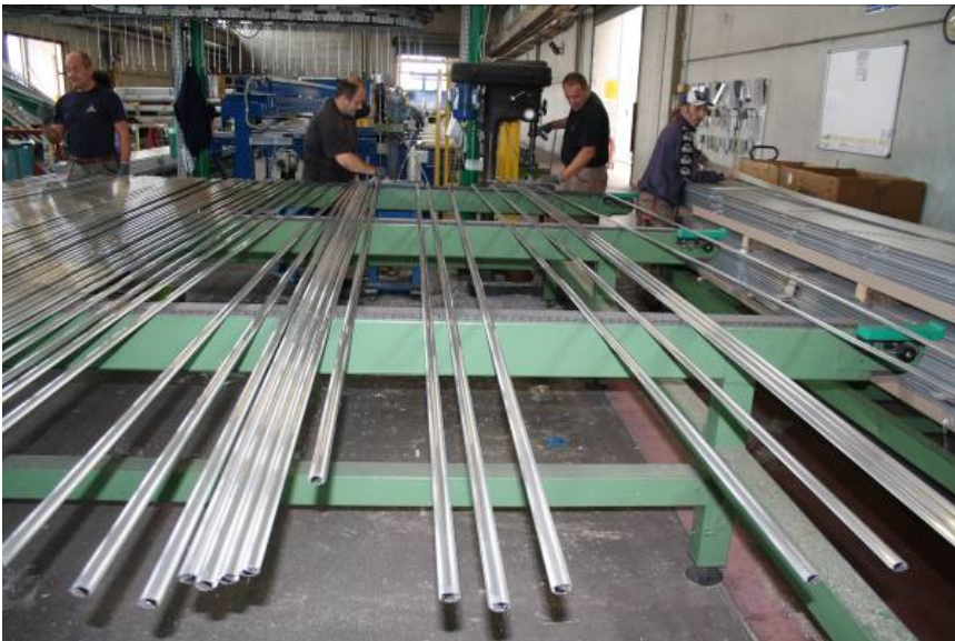
Die extrudierten Aluminium-Profile werden für die Vorbehandlung vorbereitet.
