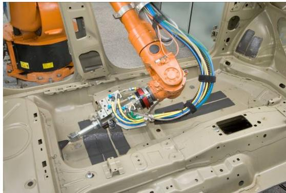
Teroson RB 8275, ein so genannter Liquid Applied Sound Deadener (LASD), sorgt für die deutliche Reduzierung des beim Fahren vom Motor und den Rädern ausgehenden Körperschalls.
