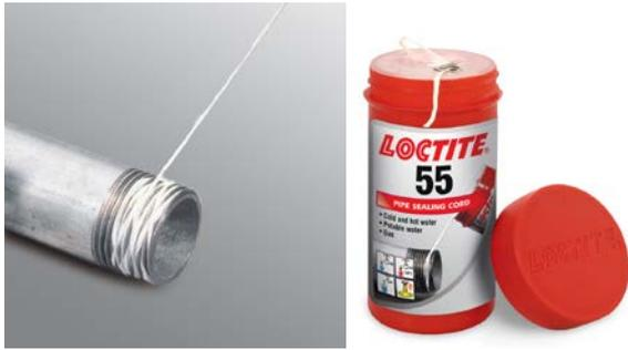
Moderne Gewindedichtungslösungen auf Basis von technischen Garnen (Loctite 55) erzielen sofortige Dichtwirkung. Der gesamte Montagevorgang wird erheblich beschleunigt, und Verbindungen können nach dem Anziehen nachjustiert werden – so werden Undichtigkeiten vermieden.
