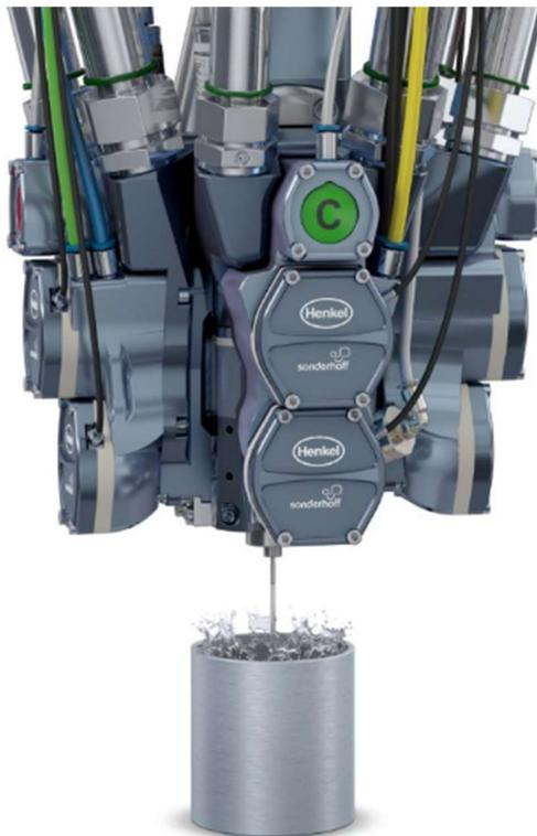
Sensorgesteuerter 2/3-Komponenten-Mischkopf MK 800 PRO mit ökologischer Hochdruckwasserspülung zur Reinigung der Mischkammer von Materialanhaftungen reaktiver Materialien zum Dichten, Kleben und Vergießen.
