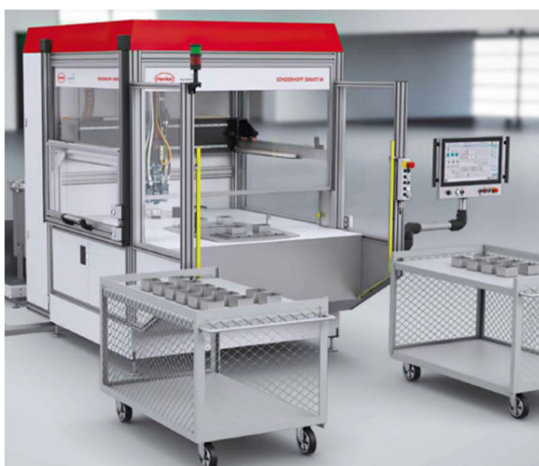
Dosierzelle Smart-M mit Rundtakttisch, der Einlegebereich ist durch ein Lichtgitter abgesichert.
