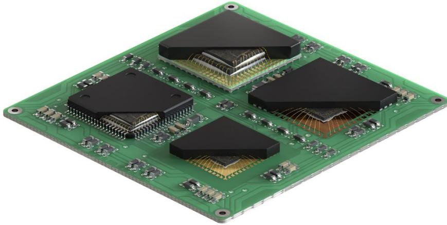
Mit einer Wärmeleitfähigkeit von 165 W/(mK) eignet sich der neue Die Attach Klebstoff optimal für hochzuverlässige Power Packages in Automobil- und Industrieanwendungen.
