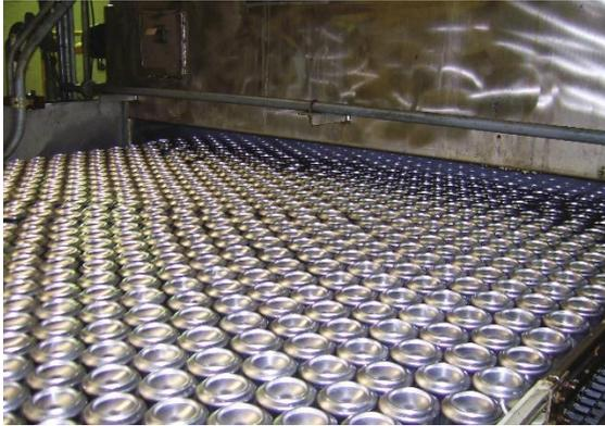
Henkel hat einen innovativen Niedrigtemperaturreiniger für Aluminium-Getränkedosen entwickelt, der in klassischen Sprühanlagen zum Einsatz kommt.
