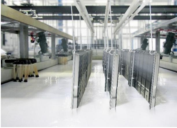
Henkel Adhesive Technologies bietet diverse Lösungen zur Vorbehandlung von Aluminium, zum Beispiel in Form von Batteriegehäusen.
