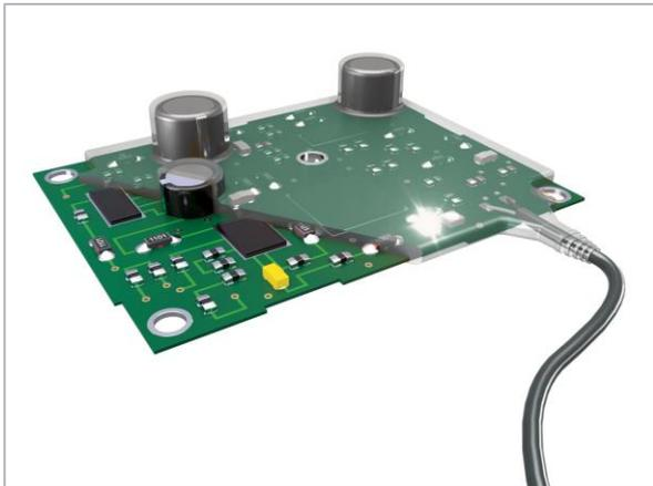
Der Niederdruckspritzguss kommt bei der Verkapselung von Leiterplatten in medizinischen Diagnose- und Beobachtungsgeräten zum Einsatz, um vor Luftfeuchtigkeit, Temperaturen und Chemikalien zu schützen.
