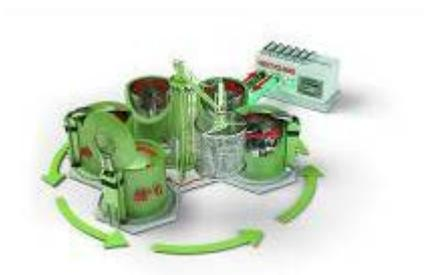
Mit den vollautomatischen Loctite Imprägnierverfahren mit Recyclingsystem können sämtliche Porositäten in Metallbauteilen abgedichtet werden.
