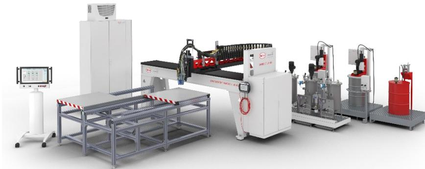
Die neue Dosiermaschinengeneration DM 503 für vollautomatische Verarbeitung und Dosierung von Dichtungsschäumen, Klebstoffen und Vergussmassen
