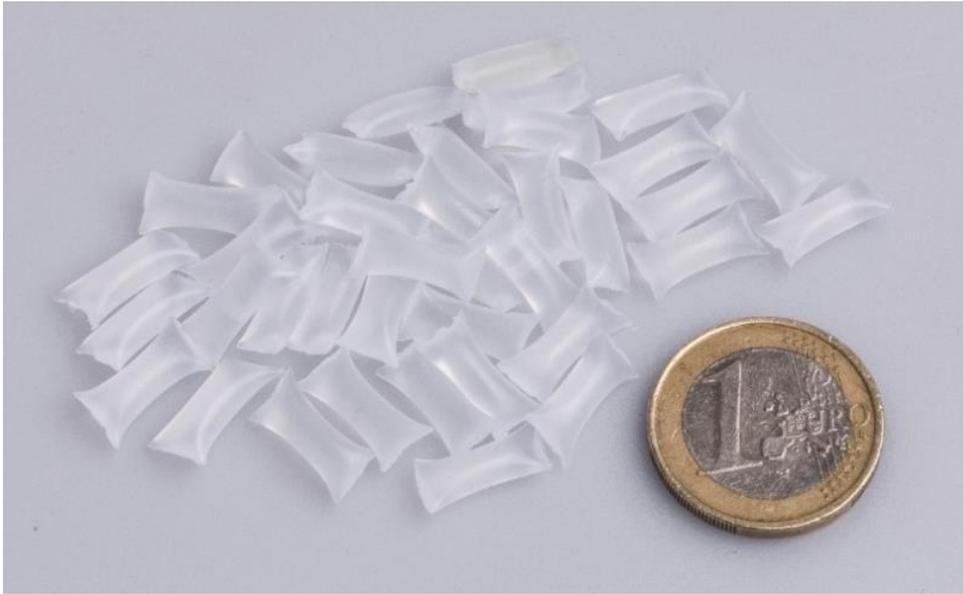
Die kleinen, nicht klebrigen Minikissen können frei fließen und ermöglichen eine automatische Zuführung in die Schmelzanalgen.
