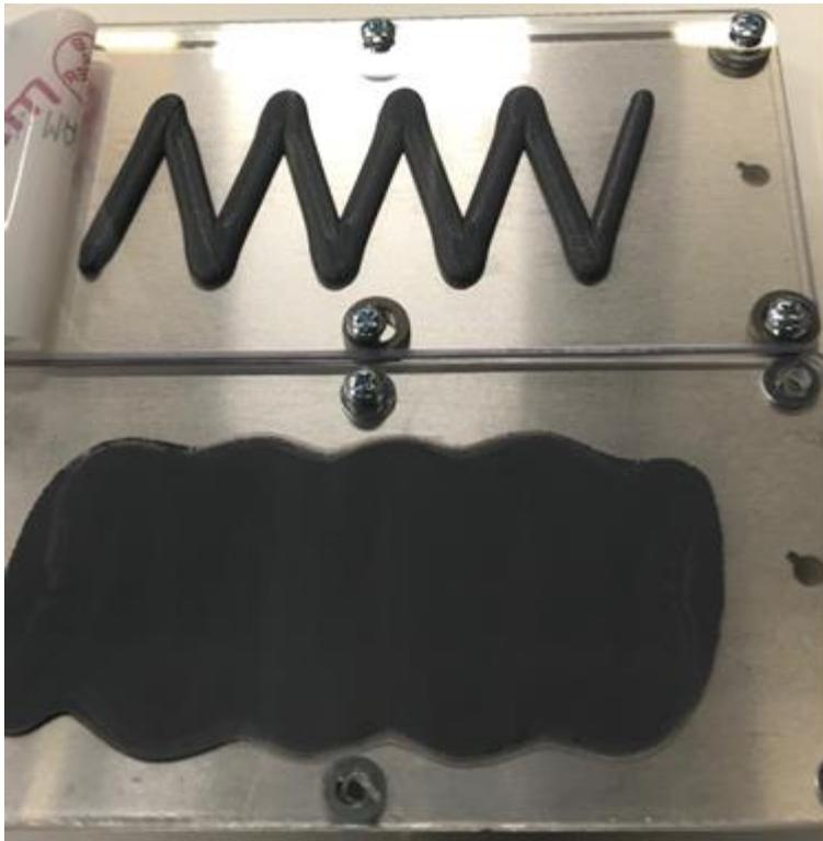
Bergquist Gap Filler TGF 3010 APS zeigt außergewöhnliche Resultate in Materialqualität und Entfernbarkeit nach beschleunigten Belastungstests, die in Henkel Laboren durchgeführt wurden.
