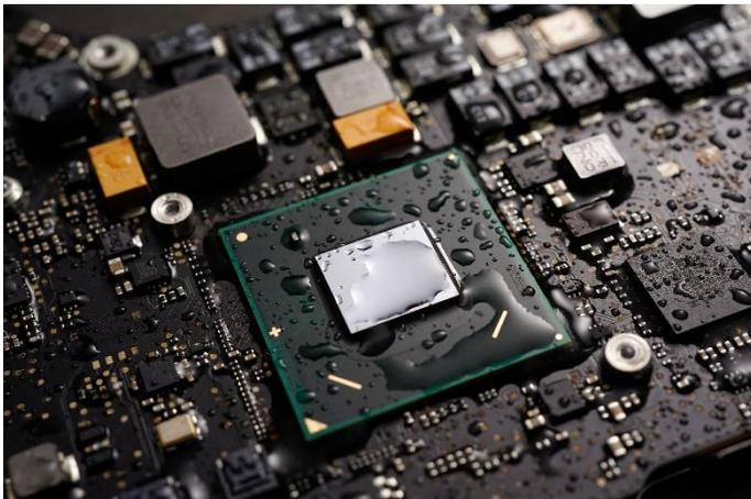
Die Beschichtungstechnologie von actnano bietet umfassende wasserbeständige Eigenschaften zum Schutz von kompletten Leiterplatten.
