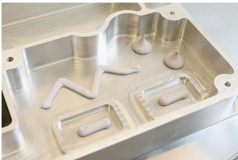
Ergebnis nach Dosierversuch mit Bergquist TGF 7000 bei Bdtronic. (Foto: Bdtronic)
