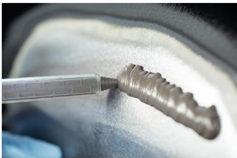
Teroson EP 5020 ist einfach aufzutragen und ergibt ein optimales Substrat für den weiteren Arbeitsprozess (z. B. Feinspachtel und Lackaufbau).
