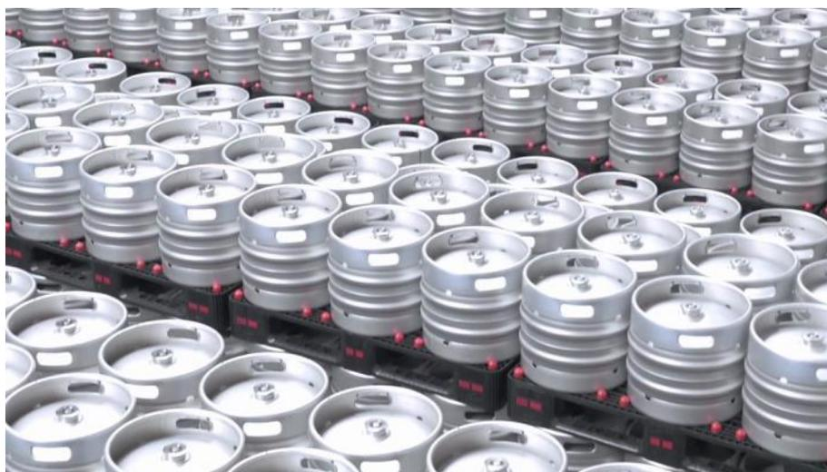
Die neue Keg-Produktionsanlage von Entinox in Saragossa verfügt über eine jährliche Kapazität von bis zu 450.000 Kegs aus austenitischem Edelstahl mit einer Oberfläche von zwei Quadratmetern pro Keg. (Foto: Entinox)
