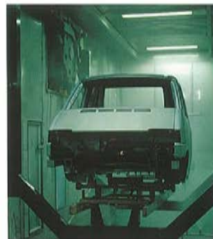
Karosserie-Vorbehandlung: Die Phosphatierung ist wichtig für die spätere Lackhaftung und den Korrosionsschutz.
