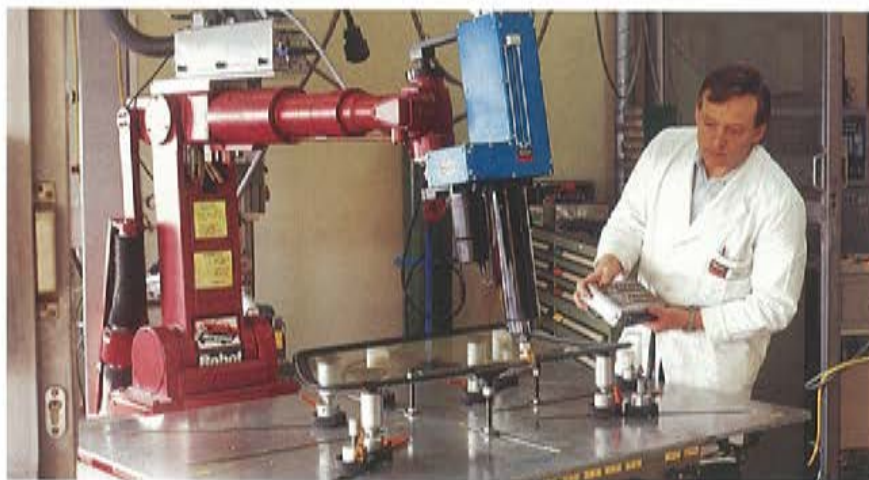
Klebstoffe für die Direkteinglasung von Autoscheiben: Test mit einem Applikationsroboter bei Henkel Teroson in Heidelberg.
