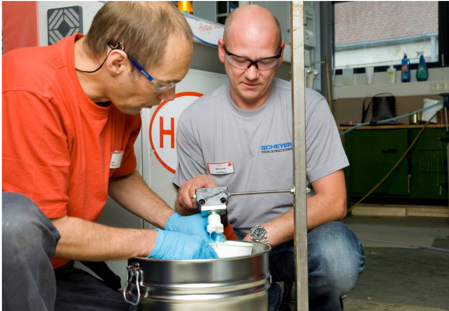
Die richtige Substratdosierung spielt beim Kaschierprozess eine wichtige Rolle.
