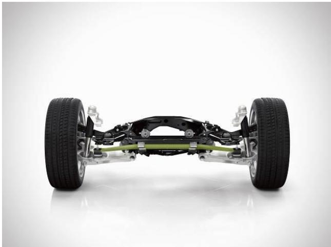
Die hintere Achse des neuen Volvo XC90 ist mit einer neuen Querblattfeder aus leichtem Verbundwerkstoff ausgerüstet. BENTELER-SGL fertigt die Blattfedern zur Hinterradaufhängung in hohen Stückzahlen aus einem Faserverbundwerkstoff mit einem Loctite Matrixharz von Henkel. (Foto: Henkel, PR008A)
