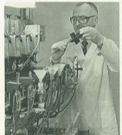
Prüfung der Phasenkontinuität im Mixer durch Messen der Leitfähigkeit.
