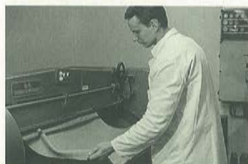
In der Ausreckmaschine wird das Leder in Form gebracht.
