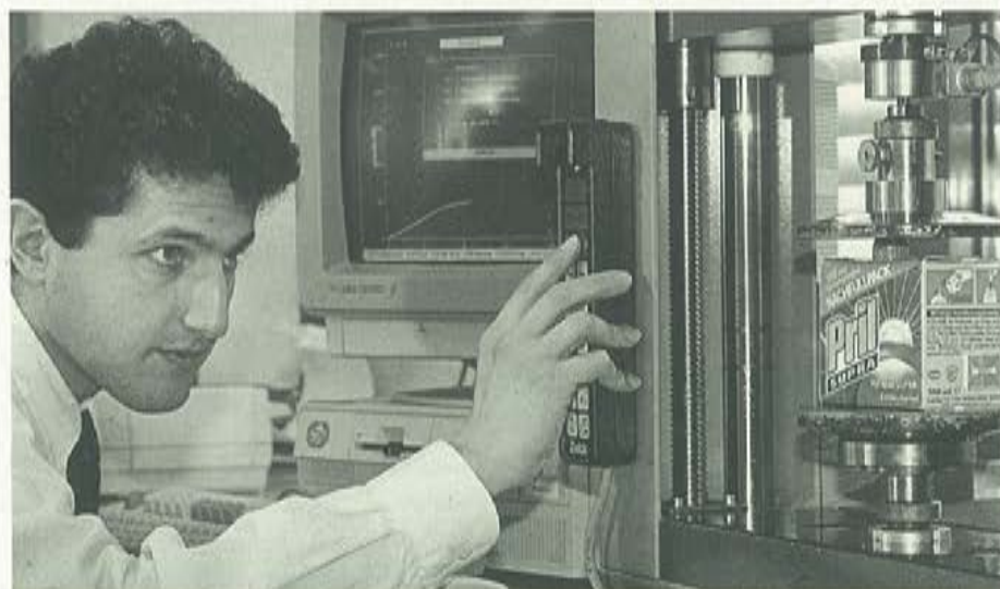
Auch die Nachfüllkartons für Handpflmittel werden auf ihre Belastbarkeit überprüft. Fachleute nennen diesen Hartetest Stauchwiderstandsprufung.
