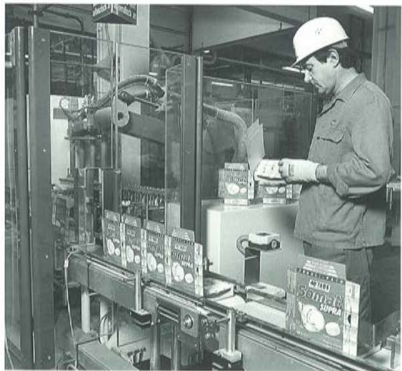
Mit Hilfe einer neuen Maschinenteknik in der Produktion werden Reiniger-Tabletten zum maschinellen Geschirrspülen jetzt lagenweise in die Schachtel gelegt.
