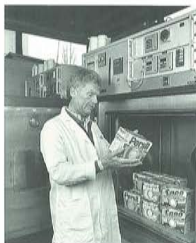
In der Verpackungsentwicklung werden die Megaperls-Packungen nach Lagerung unter Temperatureinfluß geprüft.
