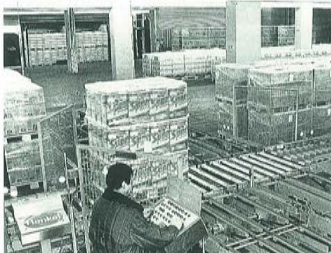
Moderne Computertechnik steuert den Versand der einzelnen Waschmittelpaletten. Mit einem elektronisch lesbaren Strichcode markiert, rollen sie automatisch an die richtige Laderampe.
