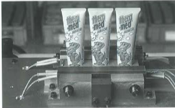
Teststation für die Versiegelung von Zahncreme-Tuben und Standhilfen aus Pappe: Die Tuben müssen im Handel vor unbefugtem Öffnen gesichert sein.
