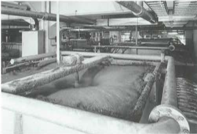
Flotationsverfahren in einer Papierfabrik: Bei der Altpapier-Aufbereitung werden Druckfarben entfernt.
