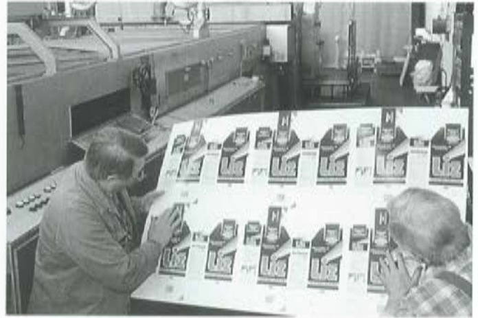
Qualitätsprüfung in der Henkel-Druckerei: Die Trocknung unter UV-Licht hat sich bei Schutzlacken für Verpackungen bewährt.
