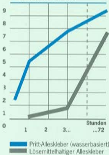
Zeitabhängiges Festigkeitsverhalten an Holz
